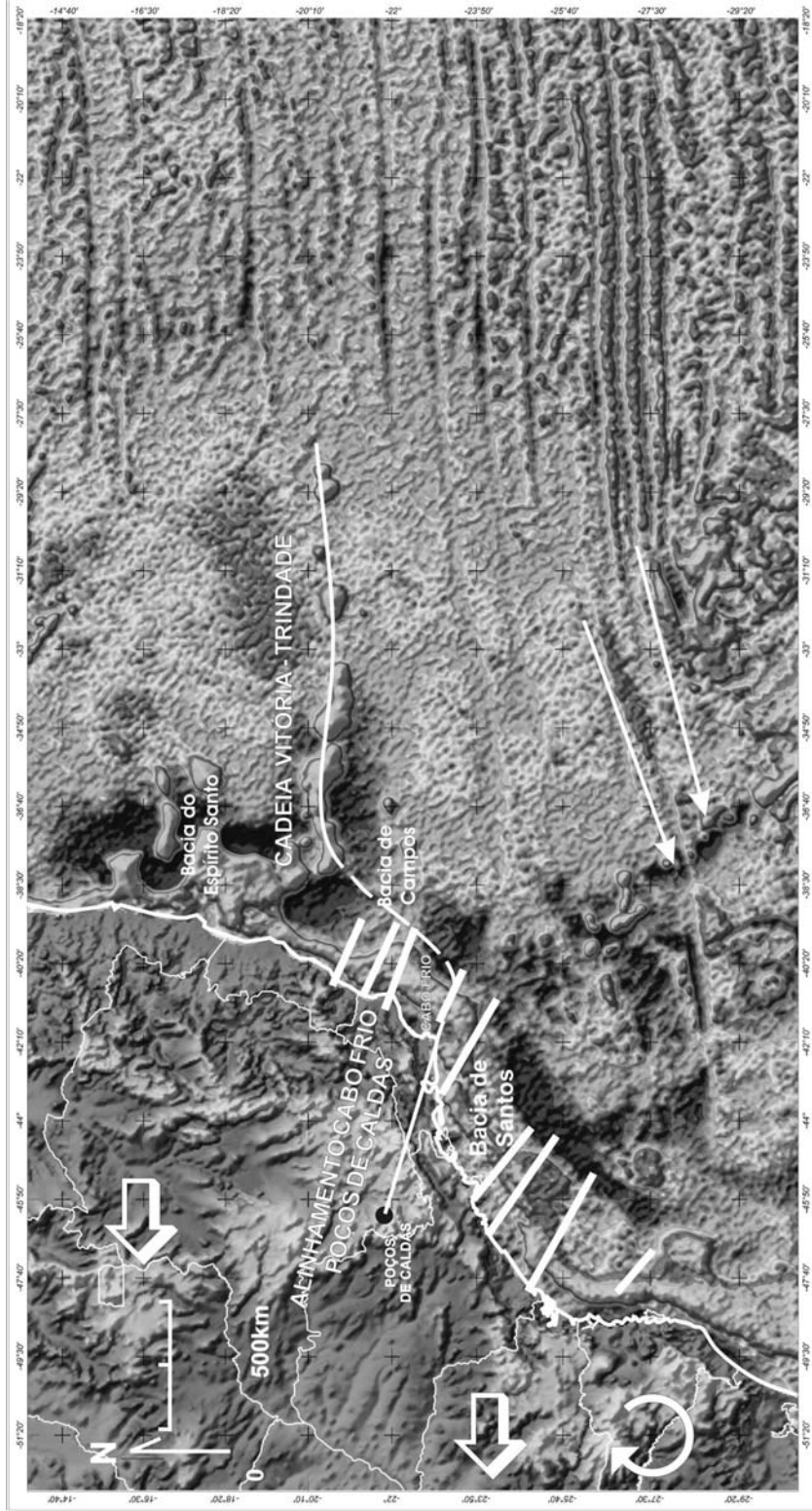
Figura 2 Mapa de parte do Oceano Atlântico Sul e da América do sul, mostrando as anomalias gravimétricas marinhas obtidas a partir da altimetria de satélite (modificado de Sandwell e Smith, 1995). Estão salientadas as falhas transformantes situadas mais ao sul e mais próximas da América do Sul, além das falhas de transferência das bacias de Santos e Campos (modificado de Meisling et al. , 2001).
