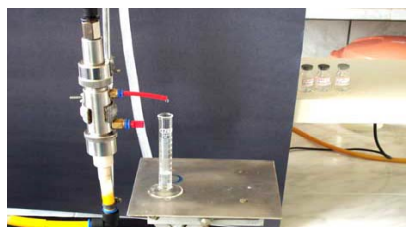
Figura 4 – Detalhe da célula mostrando a coleta da água após a separação da água no óleo.
