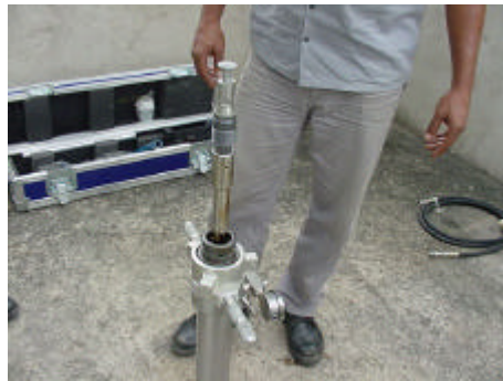
Figura 1. Equipamento Hidráulico utilizado para instalação dos sistemas de monitoração em campo
