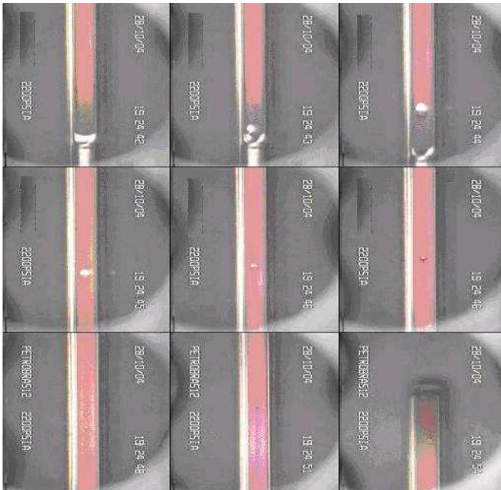
Figura 2 - Determinação da PMM de CO 2 puro em uma amostra de óleo no RBA do LAPEG/UNIFACS.
