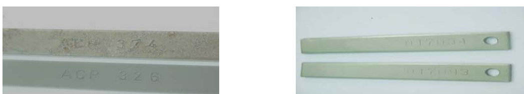
Figura 4. Cupom de aço carbono (ACP 374), à esquerda, e cupom de aço inox (017034), à direita.
