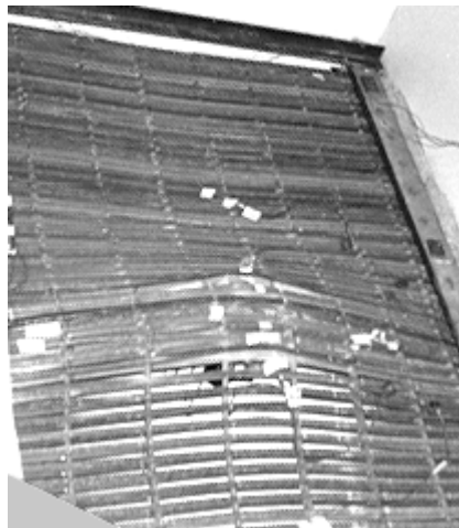
Figura 5 - Aspecto de uma grade de piso fabricada com resina poliéster reforçada com fibras de vidro submetida a uma carga concentrada no centro do vão em um ambiente mantido à 90^\circ\text{C} (Abd, 1999)
