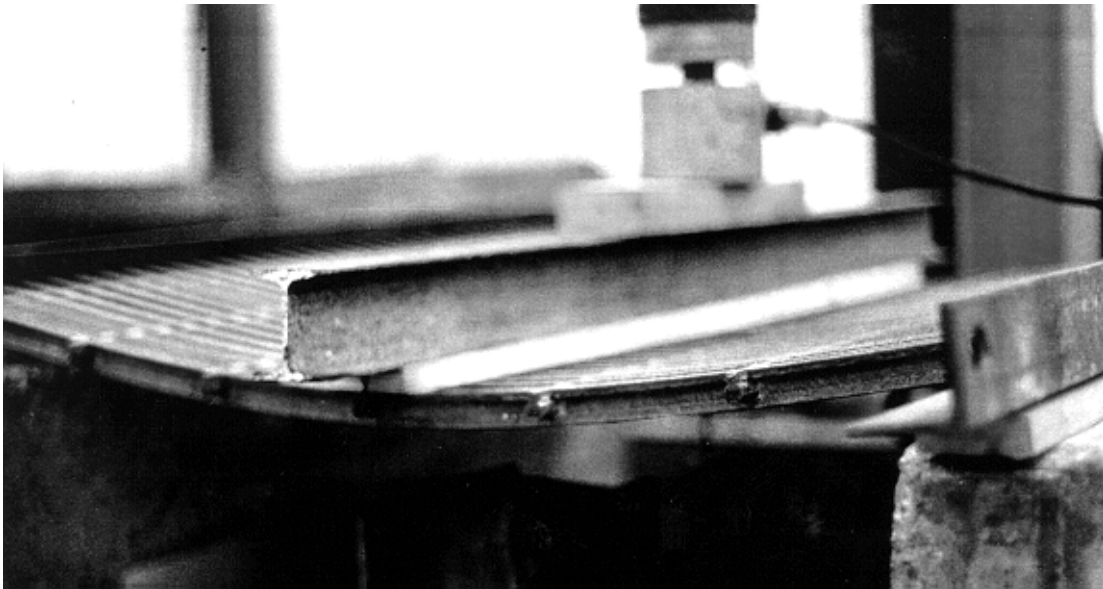
Figura 2 - Ensaio à temperatura ambiente atestam a grande resistência mecânica de grades de piso fabricadas em compósitos (Batista, 1998).
