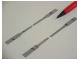
Figura 6. Corpos de Prova rompidos.
