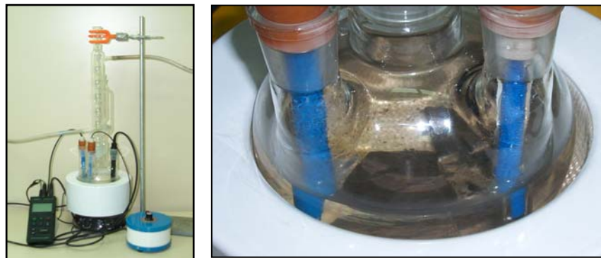
Figura 1. Equipamento desenvolvido para a realização dos ensaios de imersão (esquerda) e vista das amostras de folhelho imersas em solução no interior do balão (direita).
