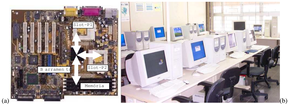
Figura 2: Em (a) placa mãe ASUS-CUV4X-DLS com slot para 2 processadores. Em (b) exemplo de um “cluster de workstation” (LMPT-Laboratório de Meios Porosos e Propriedades Termofísicas).
