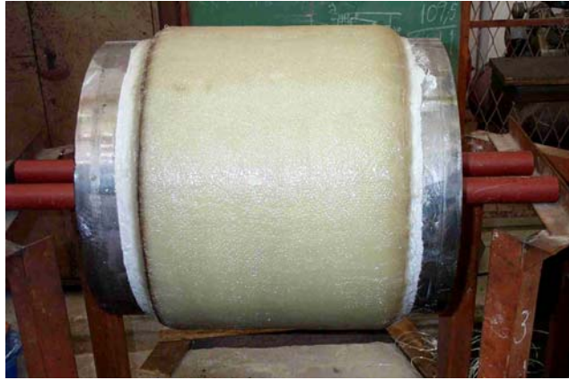
Figura 3. Material compósito 1 aplicado em um segmento de duto de aço
