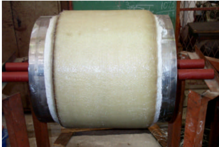
Figura 1 – Foto ilustrativa do material compósito aplicado sobre um segmento de duto.
