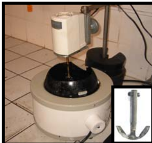
Figura 2: Sistema utilizado na modificação do CAP pela incorporação de BPM. Palheta no detalhe.
