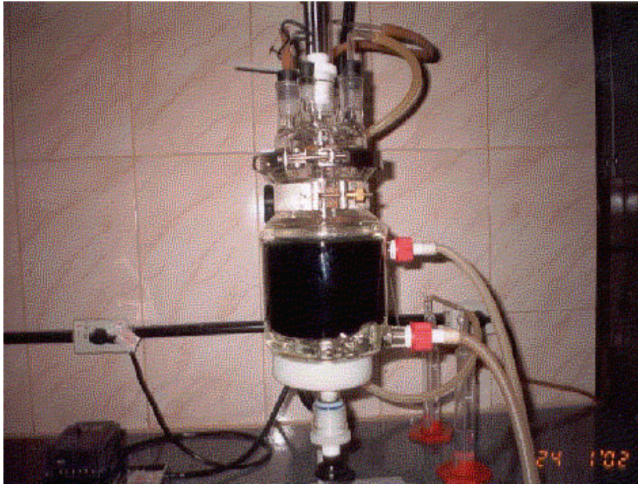
Foto 1: Biorreator anaeróbio de bancada utilizado nos experimentos.
