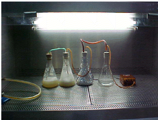
Figura 1. Sistema experimental utilizado para a produção de biossurfactante por fermentação em batelada.
