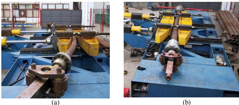
Figura 1. Espécime (a) dobrado e (b) retificado no aparato de dobramento
